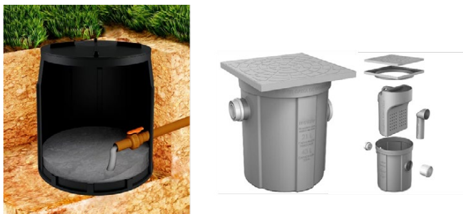
Figura 6.13 – Leito de secagem e Caixa de gordura, com componentes internos
