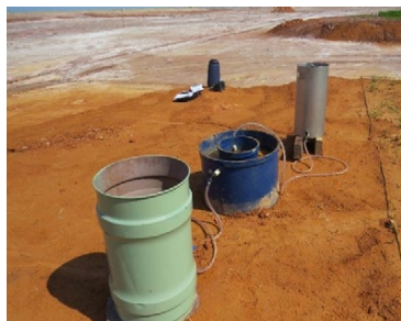
Figura 20 - Teste de Infiltração realizado em Latossolo Vermelho Amarelo, com alto grau de compactação
