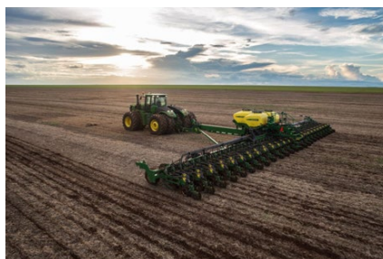
Figura 39 - Plantadeira moderna usada no sistema plantio direto
