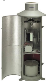
Figura 13 - Pluviógrafo: compartimentação interna
