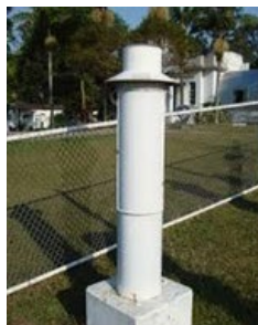
Figura 14 - Pluviógrafo: mede a Precipitação Total “P” em mm e a Intensidade da Precipitação em mm/hora
