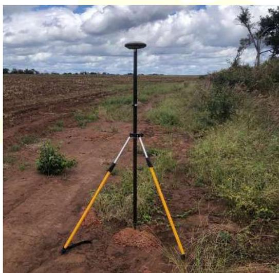
**Figura 3:** RTK utilizado no aerolevamento
