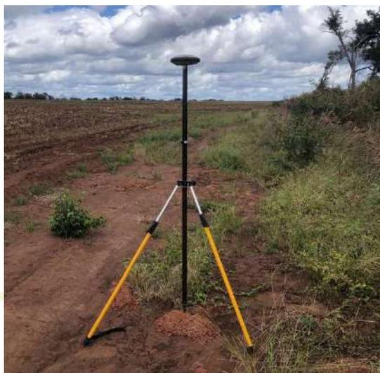
**Figura 32:** RTK utilizado no aerolevanteamento
