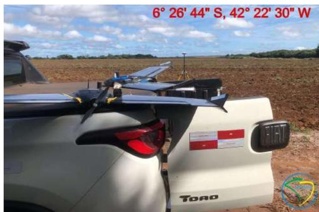
**Figura 2:** Drone Ebee Plus Sensefly utilizado no aerolevamento
