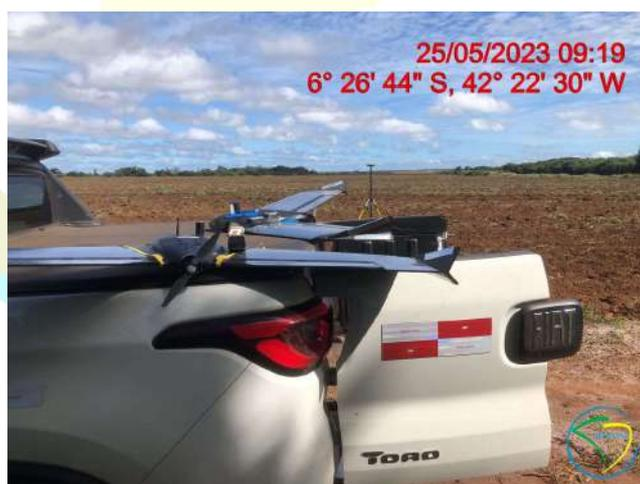
**Figura 31:** Drone Ebee Plus Sensefly utilizado no aerolevanteamento
